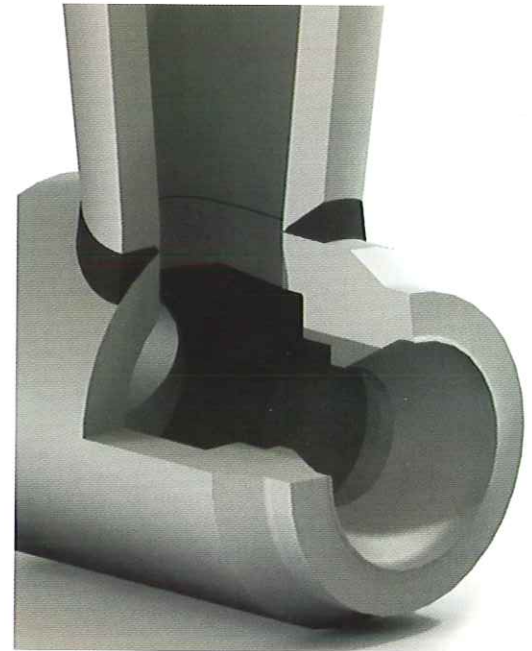
Bild 3: Armaturengehäuse mit aufgesetzten Anschweißende
