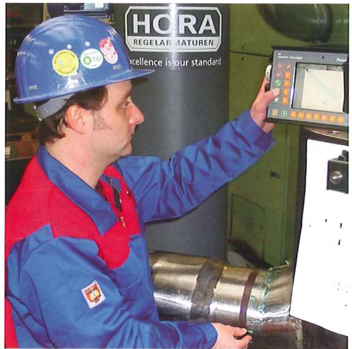
Bild 6: Schweißnahtprüfung am Bypassventil Fig. 6: Weld inspection of the bypass valve
